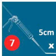
Inyecte el Fijatex E Plus en la perforación, comenzando desde el fondo y retrocediendo lentamente con el pico, cuidando de ir llenando la perforación (fig. 8).
